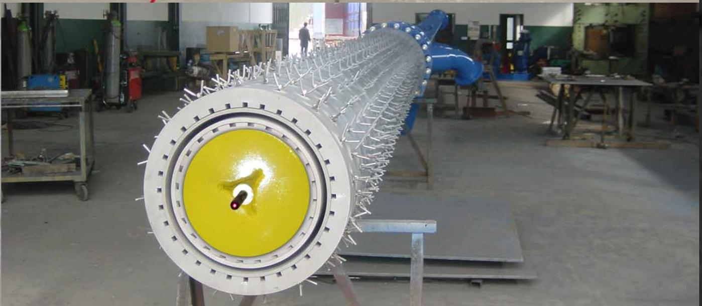
**El dispositivo de alineación del incinerador: Un objetivo fue el equipo especial diseñado para ubicarse en el medio del horno a fin de recibir un rayo láser de un puntero que se dispara a través del tubo de un incinerador o sujeto a un accesorio montado sobre la punta del quemador. El objetivo sería resistente, fácil de usar y capaz de soportar el uso repetido. El área de objetivo principal fue diseñada con un tamaño grande y para que sea de ver desde cierta distancia.**
